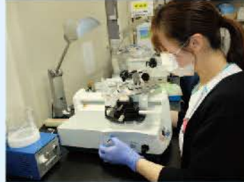
顕微鏡で観察する組織を1000分の2ミリメートルの厚さにスライスしています
